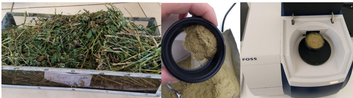
Figura 7. MS y calidad en NIRS FOSS 2500, tras molienda gruesa y fina de cada muestra compuesta.
